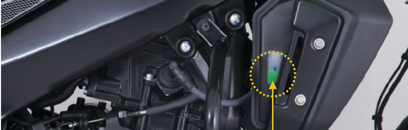
Tanque de expansión de líquido refrigerante
