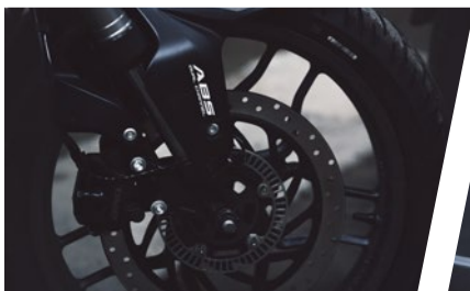
Sistema de frenos de disco + ABS Monocanal
