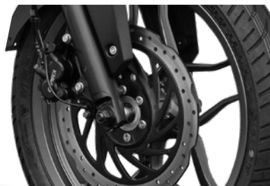
Sistema de frenos de disco Delantero 300mm, trasero 230mm.
